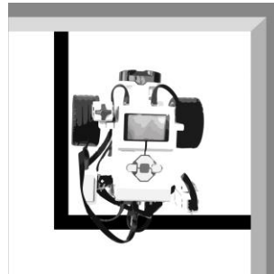
Projekcija robota je potpuno unutar startne / parking pozicije, a kablovi su van, što je sasvim u redu.
